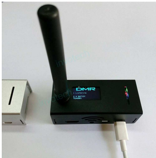
Fot. 10.12. MMDVM korzysta z dostępu do sieci WiFi w standardach 802.11b/g/n
