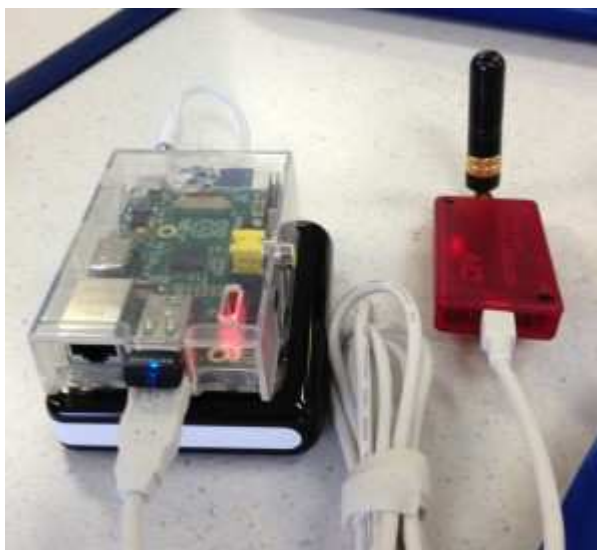
Rys. 3.1d. DVAP (po prawej stronie w czerwonej obudowie) jest innym przykładem krótkofalarskiej konstrukcji mikroprzeziennika do celów prywatnych. Może on współpracować zarówno z komputerami PC jak i z „Maliną” (tom 24). W górnym gnieździe USB powyżej szarego kabla łączącego DVAP z „Maliną” widoczne jest miniaturowy modem WiFi
