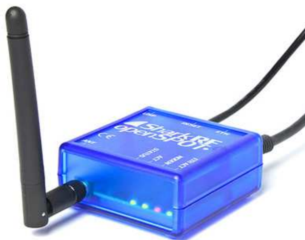
Fot. 10.6. „OpenSpot” pracuje autonomicznie bez konieczności podłączenia go do komputera ale jest wyposażony wyłącznie w złącze „Ethernet”. Pozwala za to na prowadzenie łączności skrótnych C4FM-DMR
