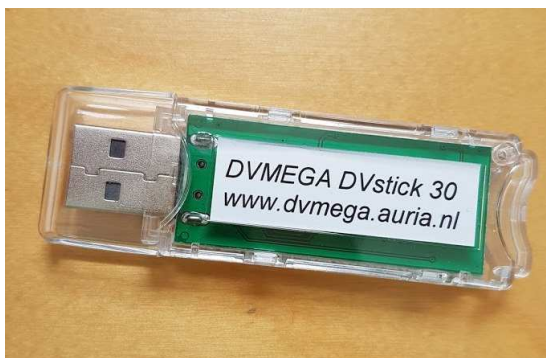
Fot. 11.3. Moduł wokodera AMBE3000 USB. Jest on podłączany do złącza USB 2.0 i zasilany przez niego. Oprócz PC i komputerów androidowych współpracuje także z serwerem „AMBE Server”
