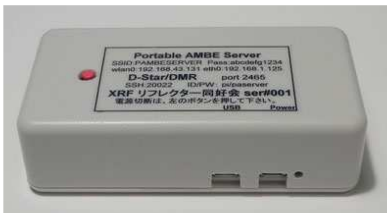
Fot. 11.9. Serwer AMBE przekodowuje sygnały foniczne na sygnały DMR lub D-Starowe i odwrotnie
