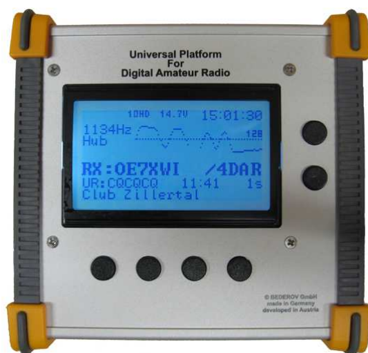
Rys. 3.1b. UP4DAR – przykład jednego z rozwiązań opracowanych przez krótkofalowców i mogącego służyć także jako przeziennik sieci. Szczegółową instrukcję obsługi zawiera tom 30 niniejszej serii. UP4DAR nie jest już obecnie produkowany i jest dostępny z drugiej ręki
