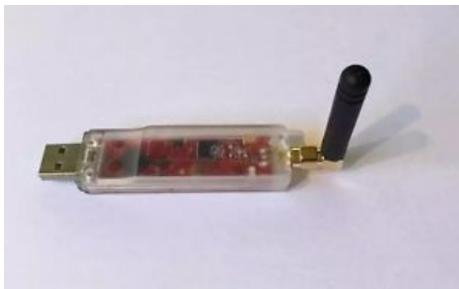
Fot. 10.1. Mikroprzeziennik DV4mini umożliwia pracę w systemach D-Star, DMR, C4FM, APCO P25, dPMR i NEXTEEDGE (NXDN). W chwili obecnej dostępne jest oprogramowanie sterujące dla Windows 7–10 i „Maliny”
