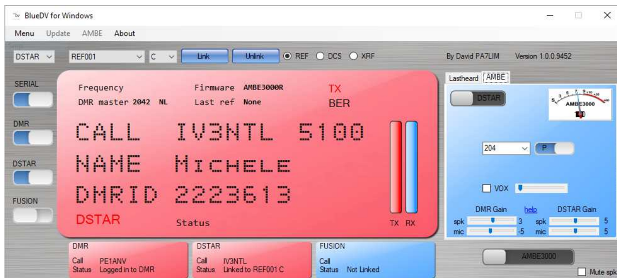
Rys. 10.9. Program „BlueDV” pozwala na korzystanie z reflektorów DXEXTRA, DPLUS i DCS w systemie D-STAR, sieci Brandmeister i DMR+ w DMR oraz reflektorów YSF i FCS w sieci C4FM. Pracuje on pod wersjami Windows od 7 wzwyż obsługując mikroprzeźniarki DVMEGA i wokoder DVStick 30.
